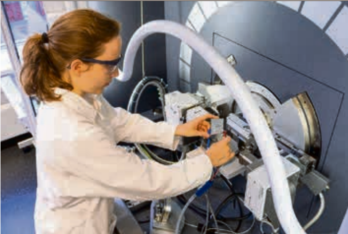
Batterieforschung: Untersuchung der Materialstruktur einer Batterie während des Betriebs mittels Röntgenbeugung (XRD).
