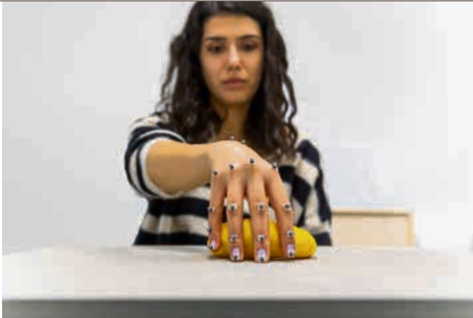
Wahrnehmungsforschung: Mit Hilfe von Algorithmen können die Kontaktflächen zwischen der Hand und dem Objekt rekonstruiert werden.
